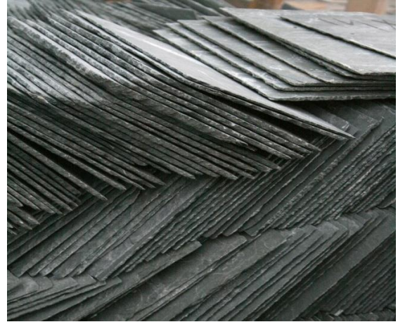
Schindeln aus Schiefer zur Dachabdeckung, Duke University's East Campus in Durham, North Carolina..Ildar Sagdejev
